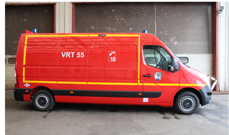
VRT • Risques technologiques Châssis fourgon tôlé 4 x 2 • 3 places
