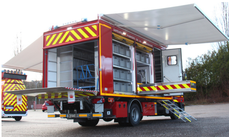
VIRT • Risques technologiques 10 T Châssis simple cabine 4 x 2 • 3 places
