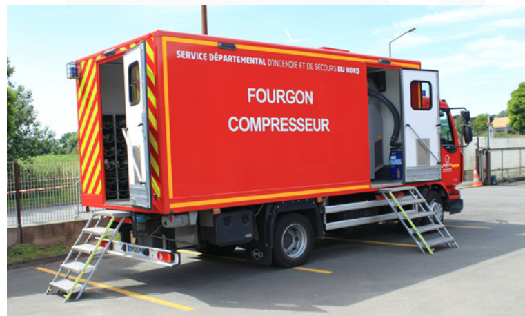
VFC • Compresseur 12 T Châssis simple cabine 4 x 2 • 2 places
