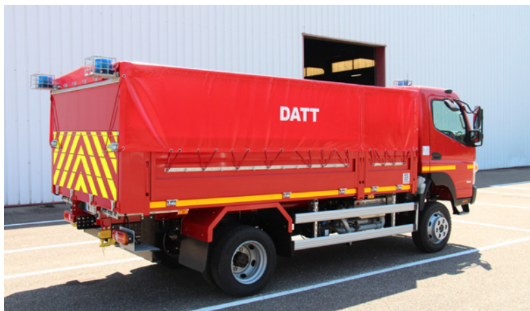
DATT • Dévidoir automobiles tout terrains 6.5 T Châssis simple cabine 4 x 4 • 3 places
