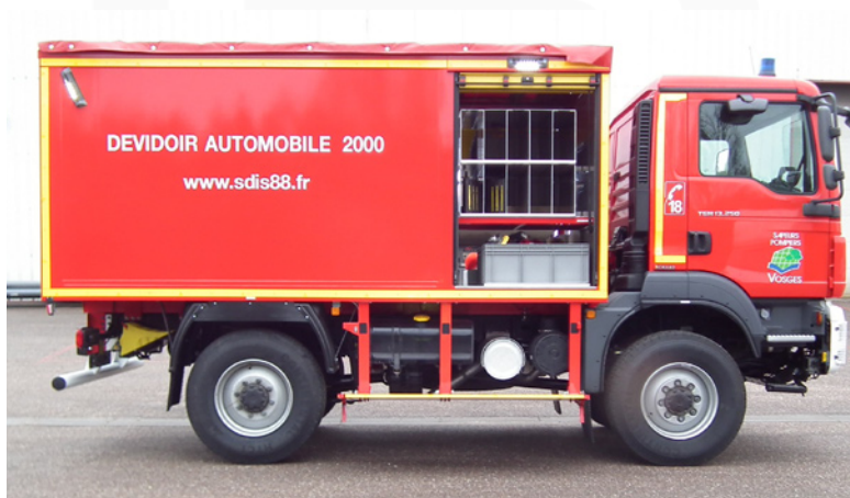
DA • Dévidoir automobiles 13 T Châssis simple cabine 4 x 4 • 3 places
