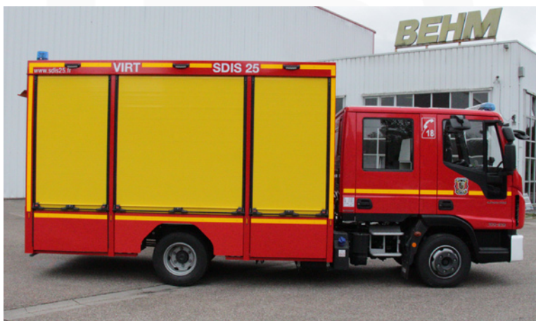
VIRT • Risques technologiques 10 T Châssis cabine double 4 x 2 • 7 places
