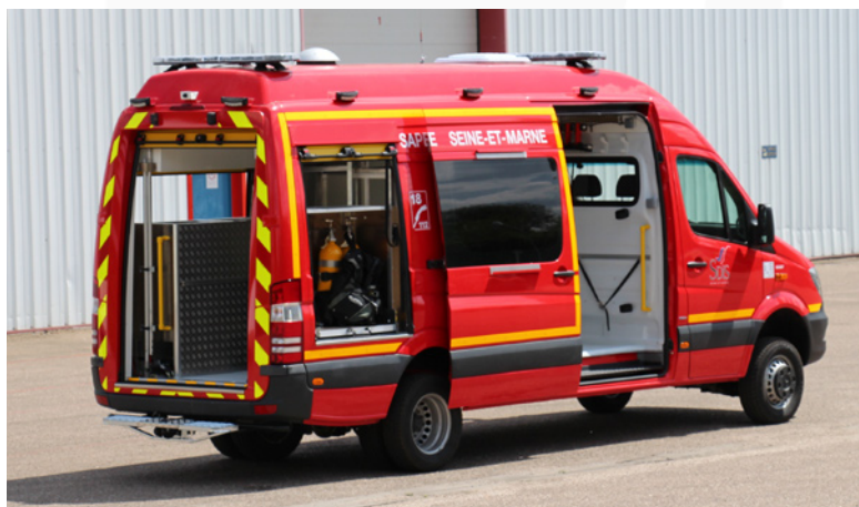
VSN • Secours nautiques 5 T Châssis simple cabine 4 x 4 • 3 places
