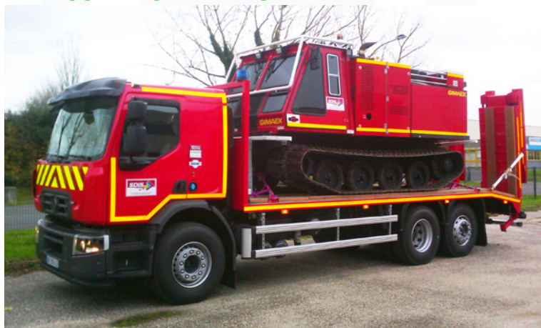
PE • Porte engin 26 T Châssis simple cabine 6 x 4 • 2 places
