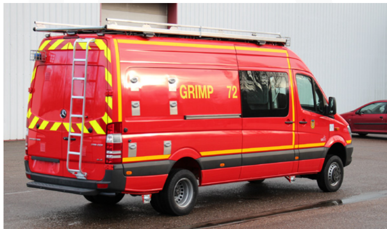
VGRIMP • Intervention Milieu Périlleux 5 T Châssis simple cabine 4 x 4 • 5 places
