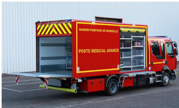
PMA • Poste médicale avancé 12 T Châssis cabine double 4 x 2 • 6 places
