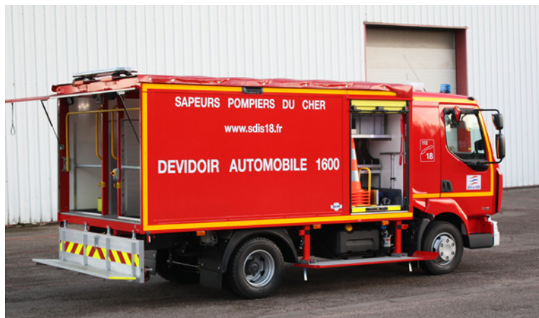
DA • Dévidoir automobiles 7.5 T Châssis simple cabine 4 x 2 • 3 places
