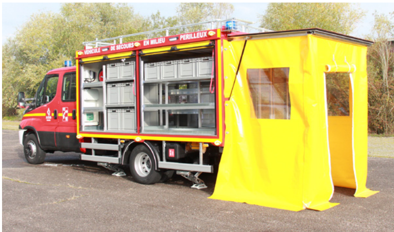
VGRIMP • Intervention Milieu Périlleux 7 T Châssis cabine double 4 x 2 • 6 places
