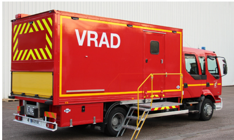
VRAD • Risques radiologiques 13 T Châssis cabine double 4 x 2 • 6 places
