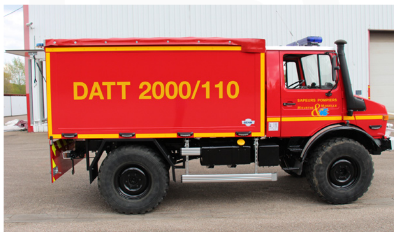
DATT • Dévidoir automobiles tout terrains 8 T Châssis simple cabine 4 x 4 • 3 places
