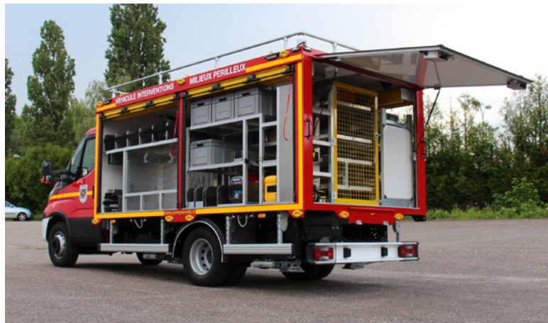
VGRIMP • Intervention Milieu Périlleux 7 T Châssis simple cabine 4 x 2 • 3 places
