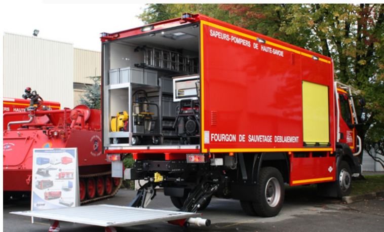
FSD • Sauvetage déblaiement 14 T Châssis simple cabine 4 x 4 • 3 places
