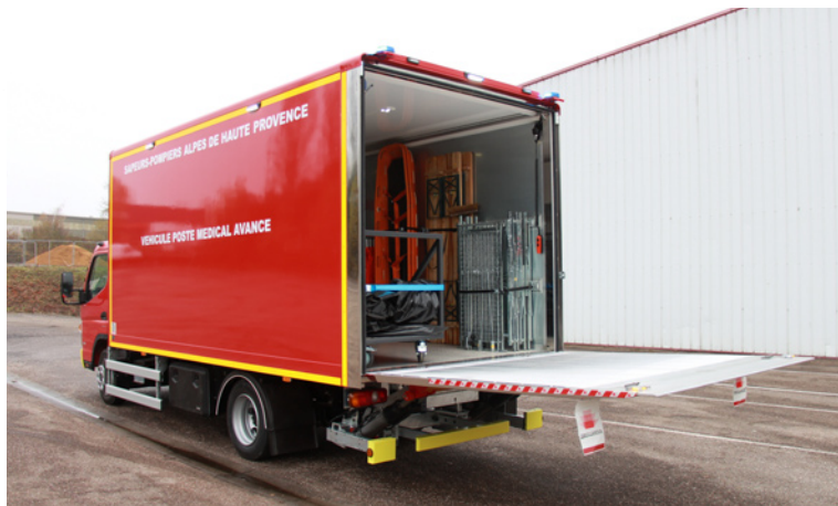
PMA • Poste médicale avancé 7.5 T Châssis simple cabine 4 x 2 • 3 places
