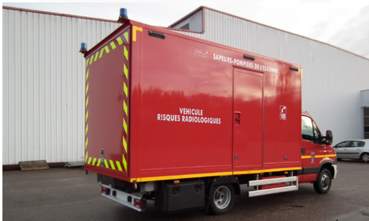
VRAD • Risques radiologiques 5.2 T Châssis simple cabine 4 x 2 • 3 places
