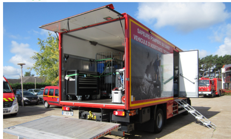
VAT • Atelier 14 T Châssis simple cabine 4 x 2 • 2 places
